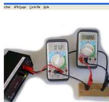
Vous avez mesuré la tension aux bornes d'une résistance et l'intensité du courant électrique qui la traverse.
